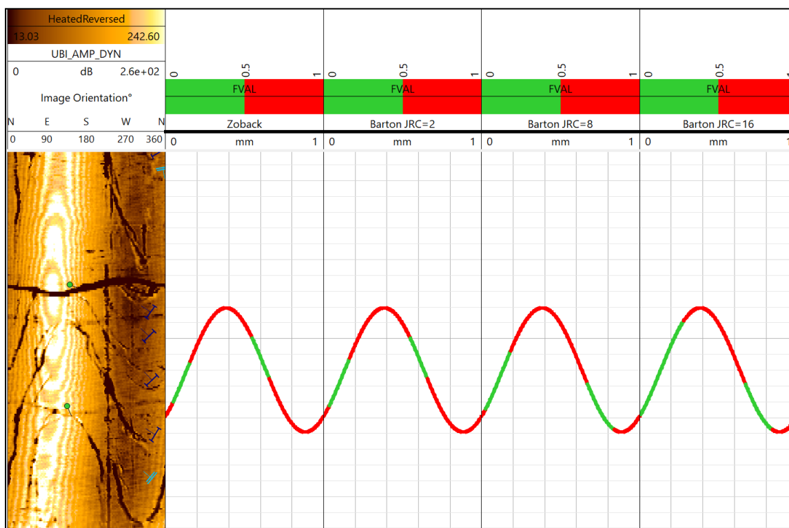
Рисунок 66 Трещина на глубине 2367,7 м результаты активности/критической напряженности для критерия сухого трения и критерия Н. Бартона
