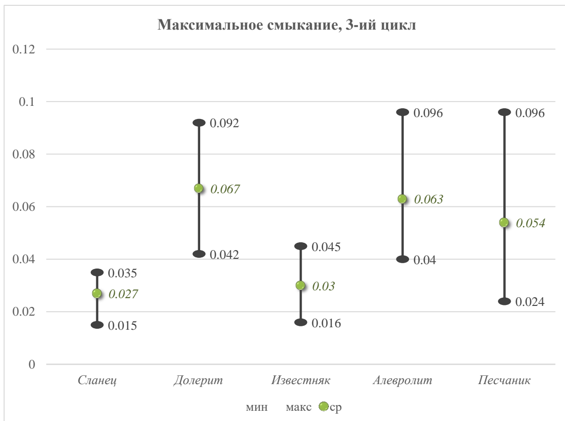
Рисунок 51 Максимальное смыкание берегов трещины для третьего цикла нагружения
