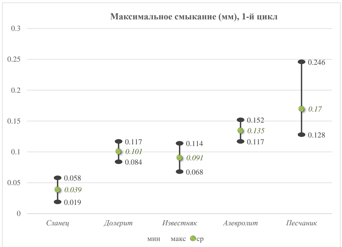
Рисунок 49 Максимальное смыкание берегов трещины для первого цикла нагружения
